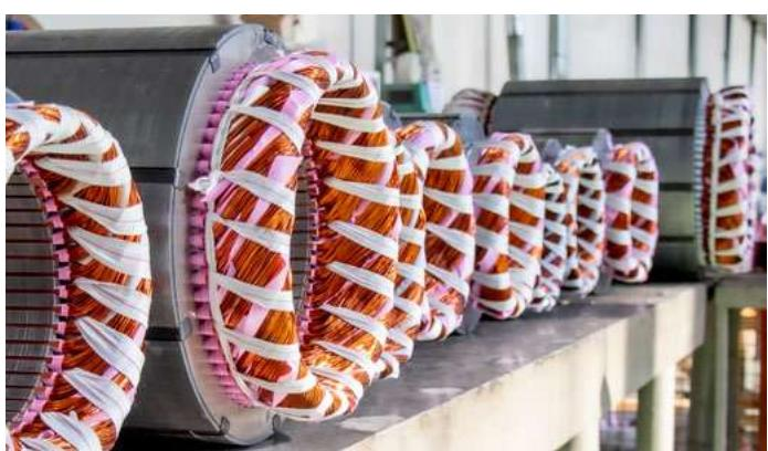
استاتور مورد استفاده در الکتروموتورهای فشار ضعیف
