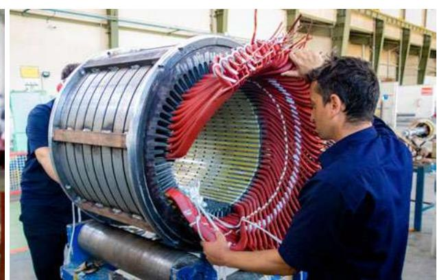
استاتور مورد استفاده در الکتروموتورهای فشار متوسط
