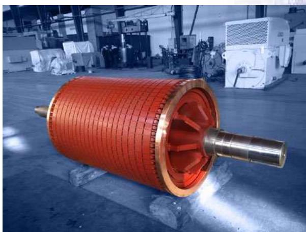
روتور مورد استفاده در الکتروموتورهای فشار متوسط
